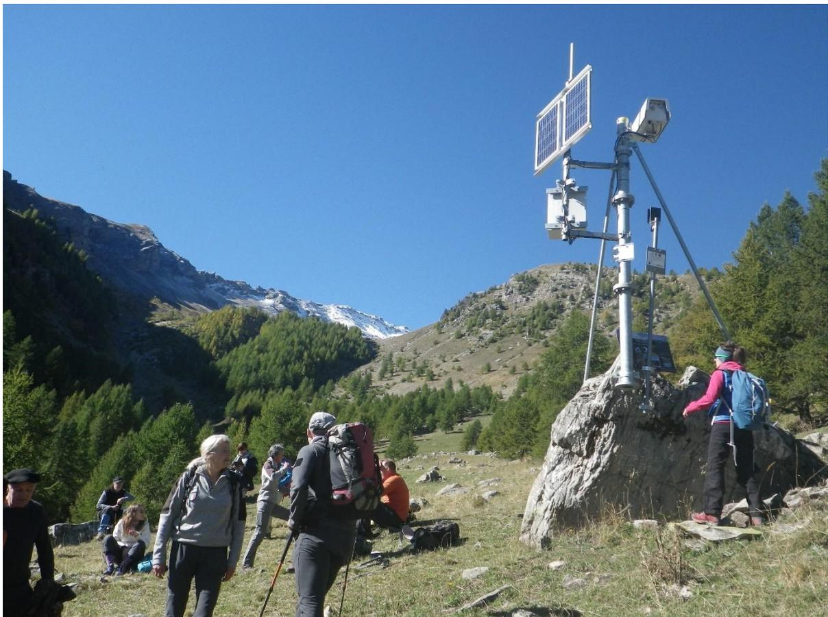
Figura 6. Fotocamera, sensore NDVI (*Normalized Difference Vegetation Index*) e stazione meteorologica installata nell'area pilota di Lautaret (foto: Mauro Bassignana)
